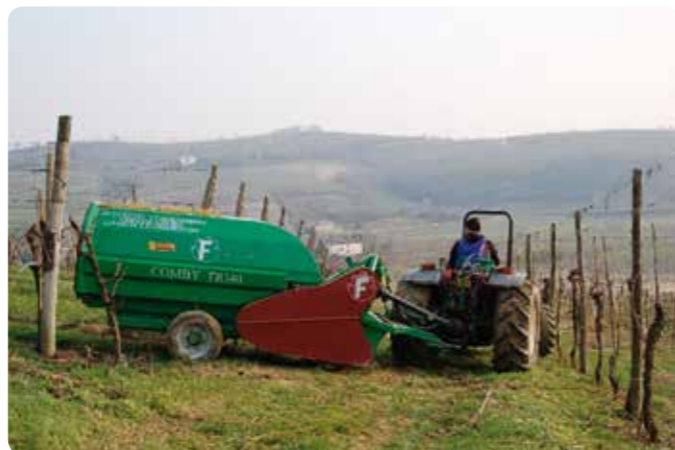
Figura 12. trincia-raccogliatrice, la FACMA Comby TR
