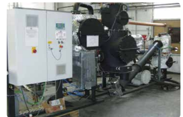
Figura 53. gassificatore di piccola taglia attualmente in commercio
