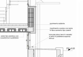
solaio piano terra tipo PLASTBAU
